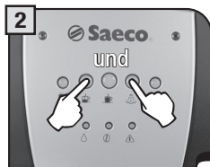
2 Die Tasten gleichzeitig drücken. Die Tasten gedrückt halten und die Maschine einschalten.
